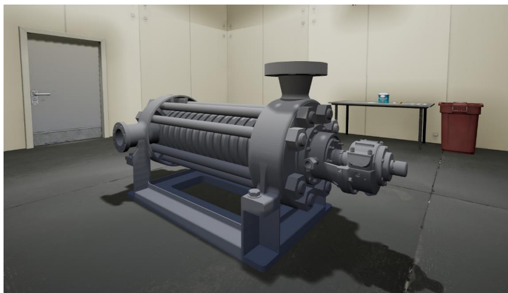
Рисунок 4. VR-тренажёр по замене торцевого уплотнения ЦНС
