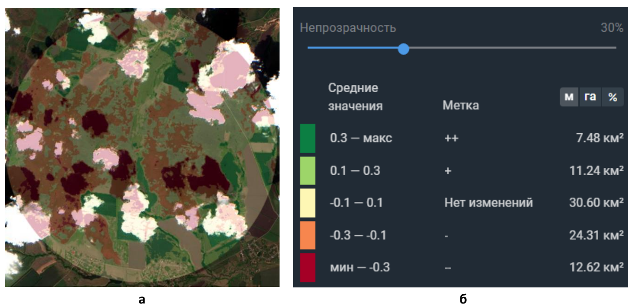
Рисунок 4. Результат рассчитанного индекса SAVI на заданной территории (а). Рассчитанные показатели на снимке (б)
